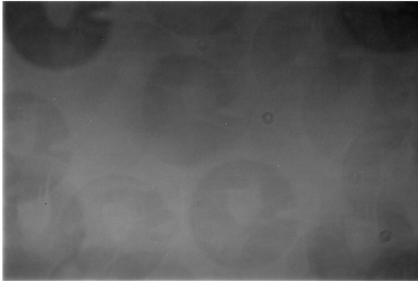
Figura 6.2: Master flat frame con esposizione di 10s. È stato aumentato il contrasto dell'immagine per rendere più evidenti le figure che si formano per i motivi elencati in precedenza.
