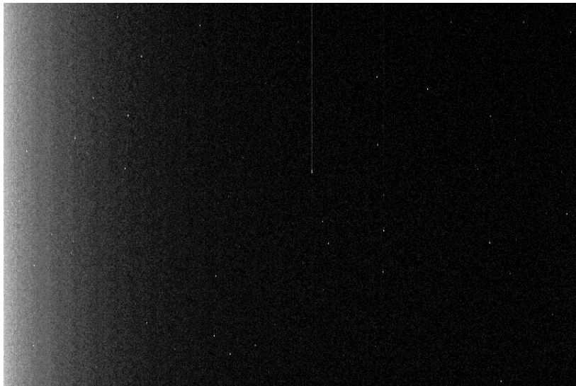
Figura 6.3: Master bias frame con esposizione di 0s. Da notare che l'estrazione e il trasporto delle informazioni contenute nei pixels del sensore avviene in un lato di questo (l'influsso di quest'attività sui pixels risulta quindi visibile a sinistra nell'immagine).
